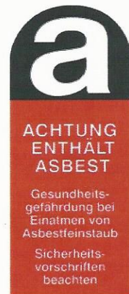
Kennzeichnung von Asbest
